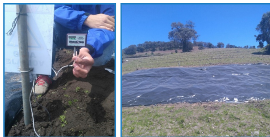
Figura 52. Montaje de plástico y software Data Logger en la toma de temperatura en dos niveles, debajo del plástico y a 15 cm de profundidad.
