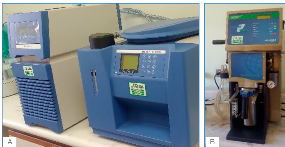
Figura 67. Equipos adquiridos para implementar nuevos servicios. A) Extractor de grasa B) Bomba calorimétrica.
