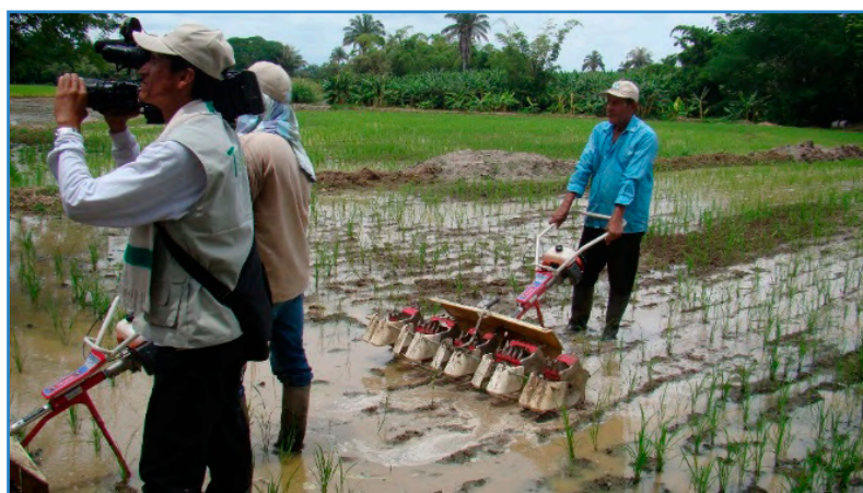
Figura 29. Sistema mecanizado para control de malezas en arroz de riego. 2018.
