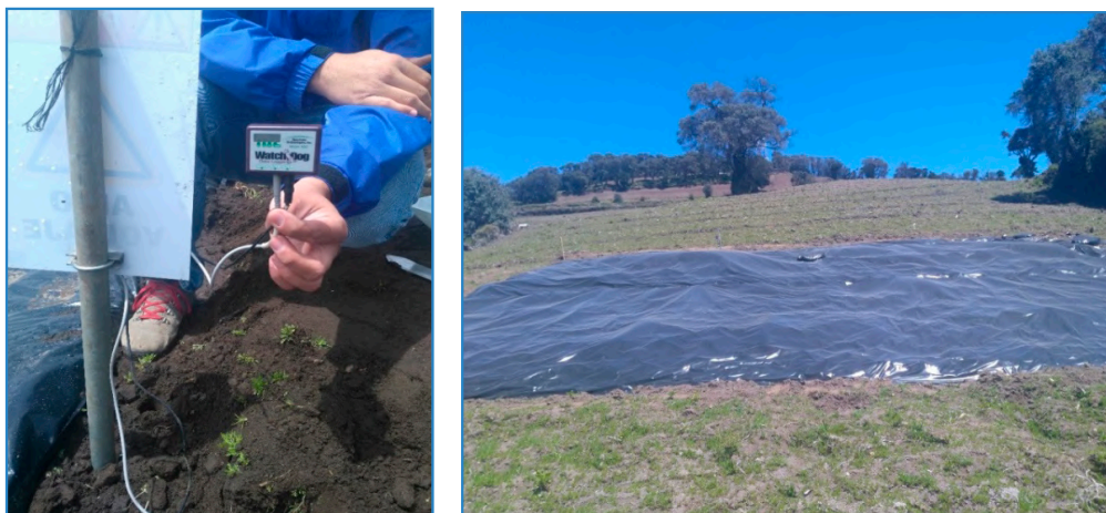
Figura 39. Montaje de plástico y software Data Logger en la toma de temperatura en dos niveles, debajo del plástico y a 15 cm de profundidad. 2017. Estación Carlos Durán. 2019.
