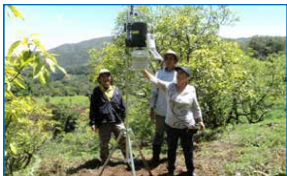
Figura 27. Estación meteorológica ubicada en una de las fincas de aguacate para obtener información climática.
